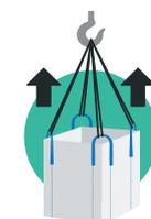
**Non consentire al personale di sostare nei pressi di un FIBC sospeso o di posizionare nessun oggetto al di sotto del FIBC.**
