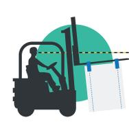
**Non inclinare in avanti il montante del carrello quando si trasporta un FIBC.**
