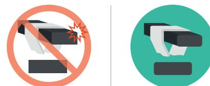
**Non consentire al personale di sostare nei pressi di un FIBC sospeso o di posizionare nessun oggetto al di sotto del FIBC.**
